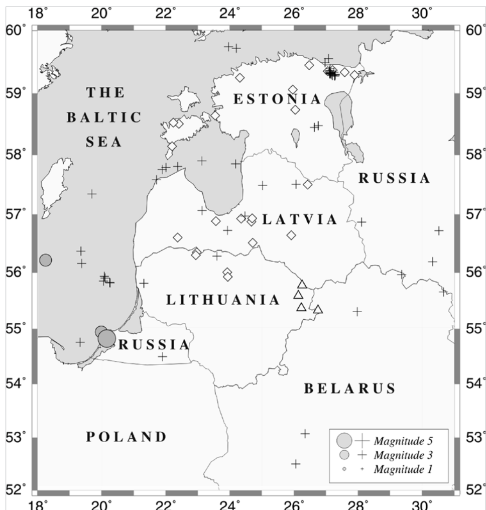
Pav. Ignalinos AE SMS 1999–2009 metais užfiksuoti vietiniai seisminiai įvykiai. Trikampiai žymi Ignalinos AE seisminės stoties, rombai – karjerus, kuriuose vykdyti sprogdinimo darbai, apskritimai – žemės drebėjimus, kryžiai – Ignalinos AE registruotus ir Lietuvos geologijos tarnyboje lokalizuotus sprogdinimus.
